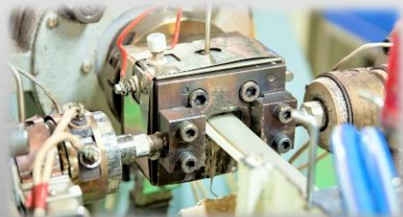
3層成形ライン Φ50×40×25mm 押出機
